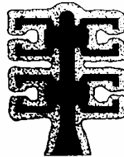
⇒ Schalenbildung durch mehrmaliges Tauchen und Besanden
